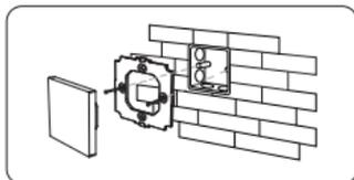
Befestigen Sie die Controller-Basis mit einer Schraube am unteren Gehäuse.
