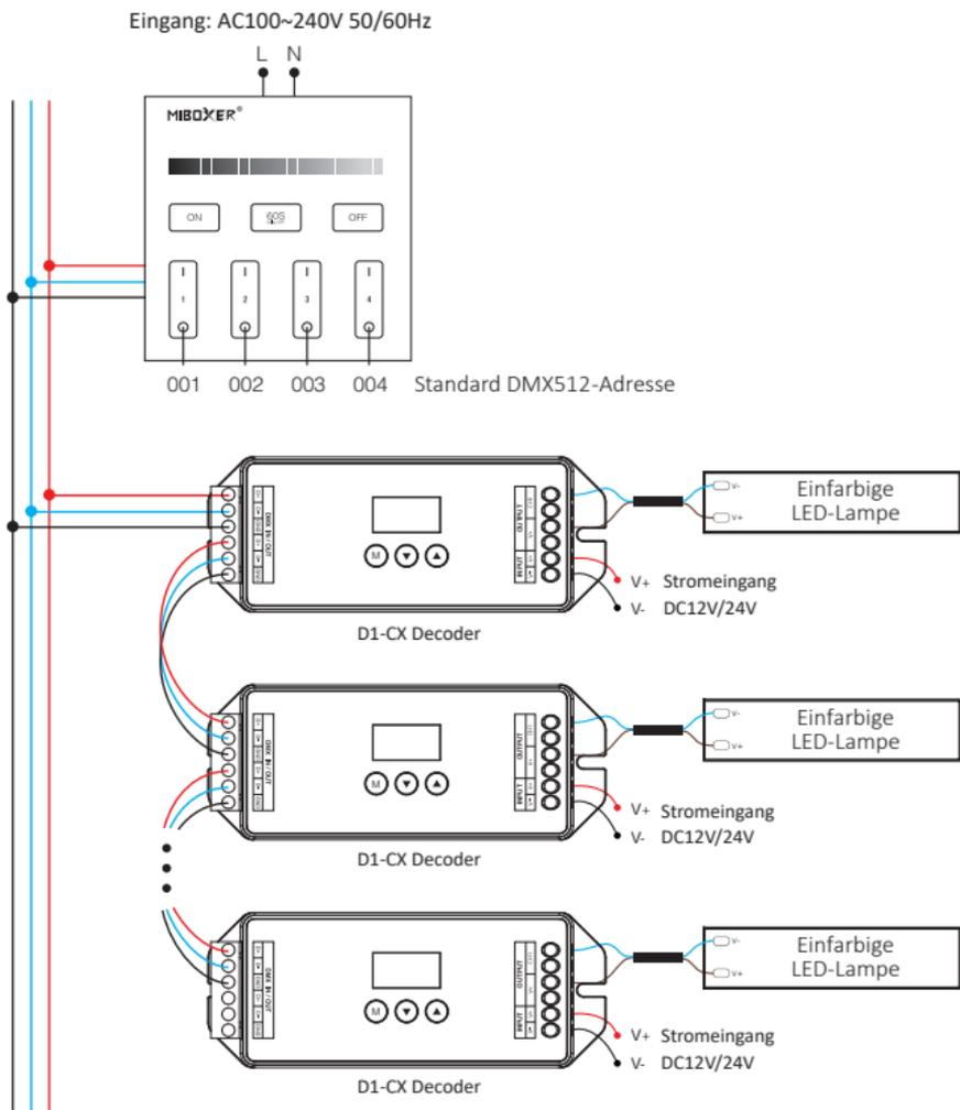
Nach der Verbindung mit DMX Decoder setzen Sie bitte die DMX-Decoder-Adresse wie unten fest:
